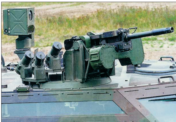
На рисунках (сверху вниз): ОБТ «Леопард-2 А5», БРМ «Феннек» и 40-мм пушка с электрическим управлением БРМ «Феннек»
