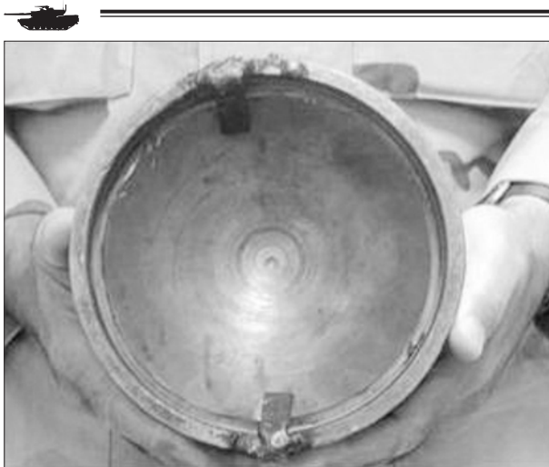
Внешний вид СВУ с поражающим элементом «ударное ядро»
