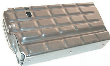
Рис. 3. 20-патронный магазин штурмовой винтовки AR-10 образца 1954 года
