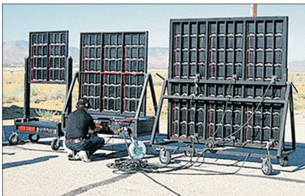
Испытание в США УВЧ-генератора, предназначенного для оттеснения людей от охраняемого периметра
