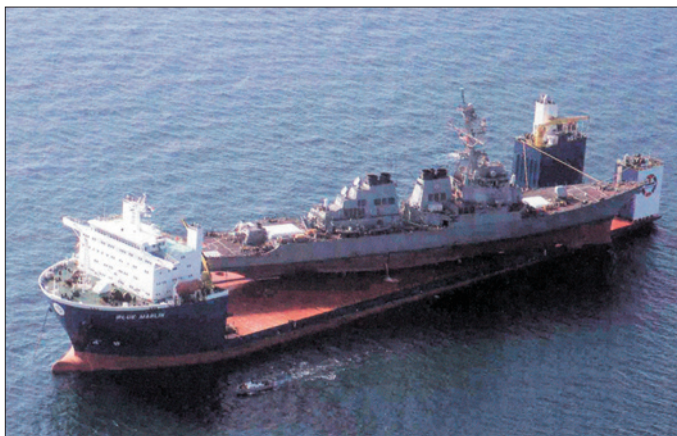
Транспортное большегрузное судно «Блю Марлин» использовалось для транспортировки в США ЭМ УРО «Коул», поврежденного взрывом в Йемене
